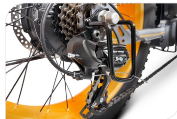
Cambio Shimano Tourney 7-velocità
