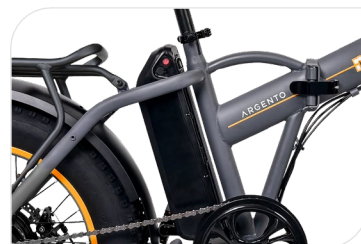
Batteria Greenway 36 V, 10.4 Ah, 375 Wh, smart BMS
