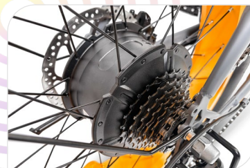
Motore Sutto Bafang, 250 W, 55 Nm
